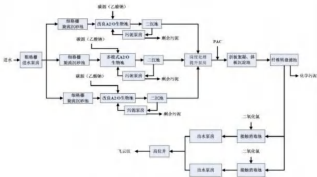
图 4-2 瑞安市江北污水处理厂处理工艺流程图
